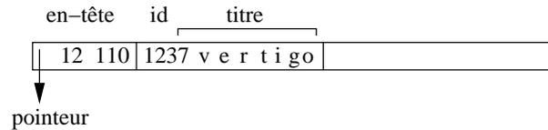
FIG. 9.6 – Exemple d'un enregistrement avec en-tête
