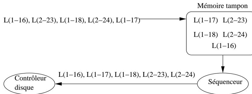
FIG. 9.4 – Séquencement des entrées/sorties
