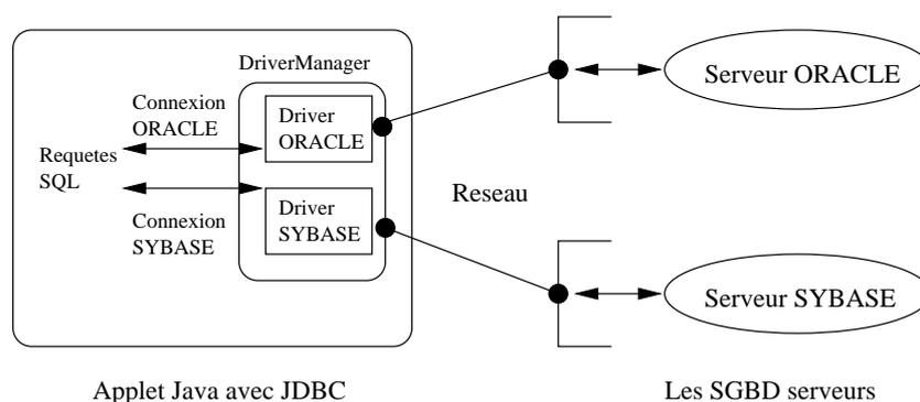
FIG. 8.1 – Mise en œuvre des drivers JDBC
